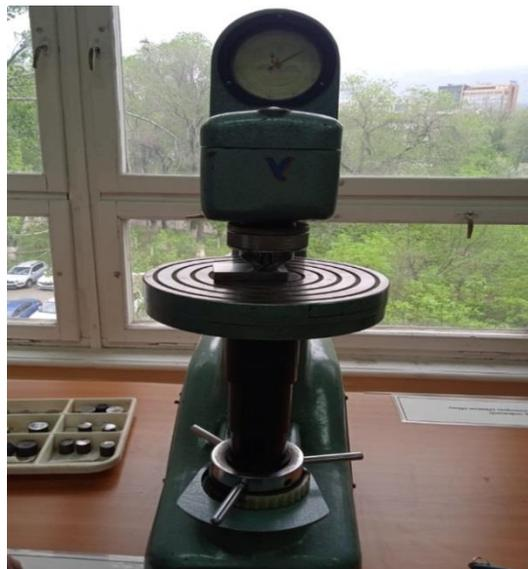
Рисунок 2.5 - Стационарный твердомер.
