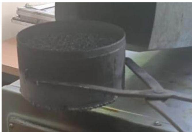
Рисунок 5.15 – Масса угля, использованная для извлечения летучих с помощью муфельной печи
