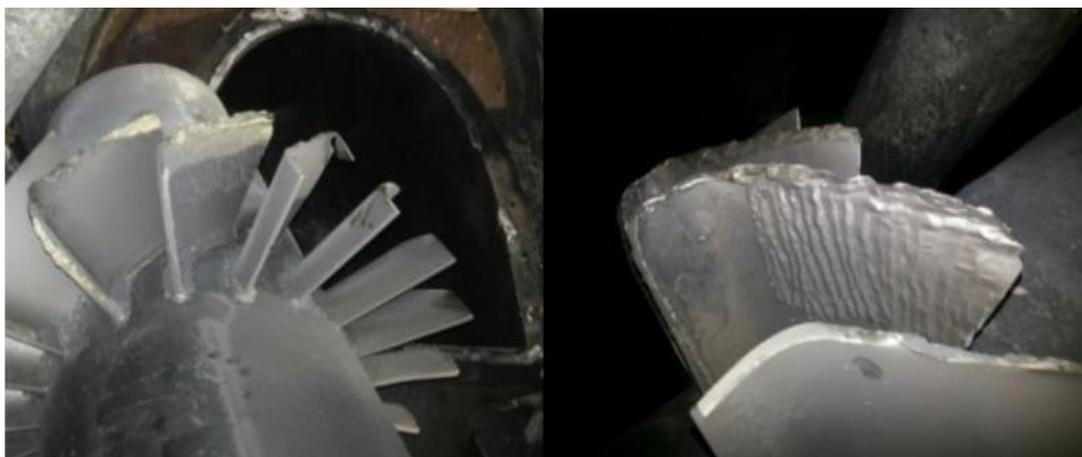
Рисунок 4.4 - Отчетливо виден абразивный износ лопаток завихрителя в канале аэросмеси пылеугольной горелки [61]
