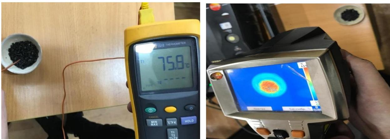
а) Инфракрасный термометр Fluke 52 II
