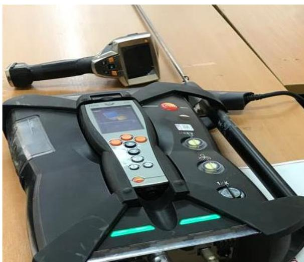
Рисунок 5.13 – Газоанализатор testo 300
