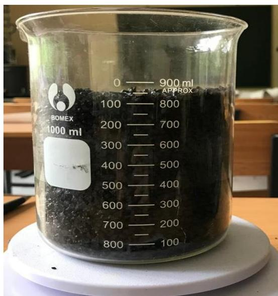
Рисунок 5.16 - Измерение веса объема частиц до и после нагревания
