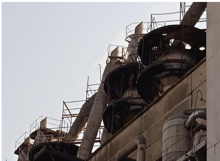
Рисунок 4.2 – Циклон. Отделитель угольных частиц для шаровой мельницы
