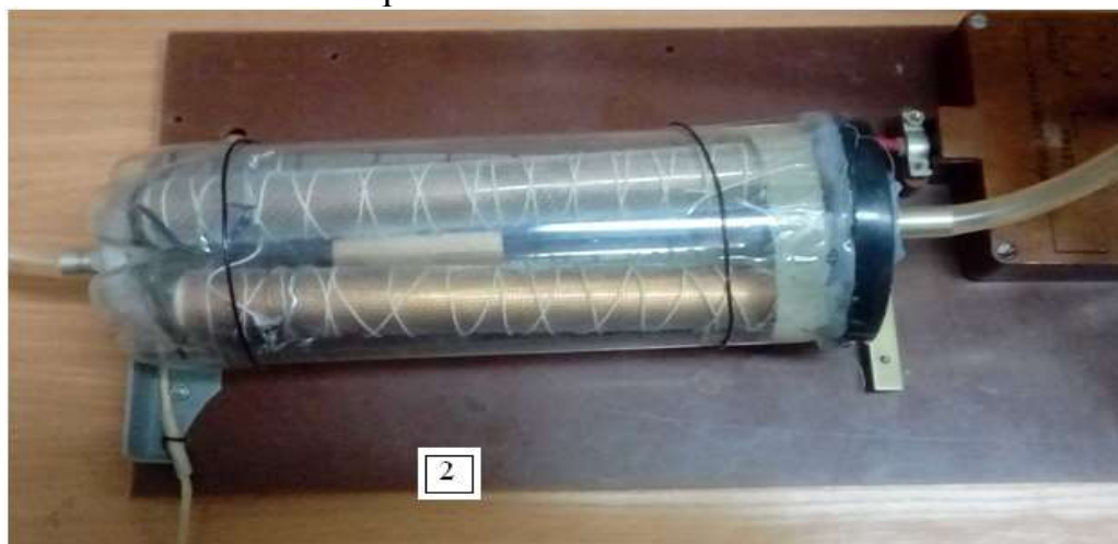
2 – озонаторные ячейки; 11 – блок с газоанализатором ОЗОН-5-200.
