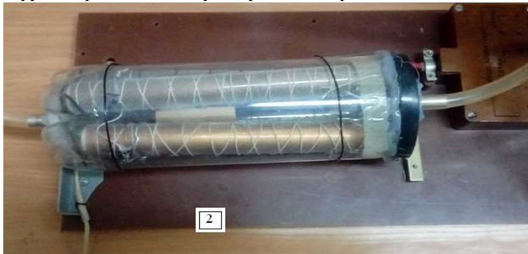
2 – озонаторлық ұяшық; 11 – ОЗОН-5-200 газталдағышы бар блок. 7 сурет – Озонаторлық ұяшықтар
